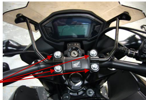
Photo 2 Vis à démonter et à remplacer
