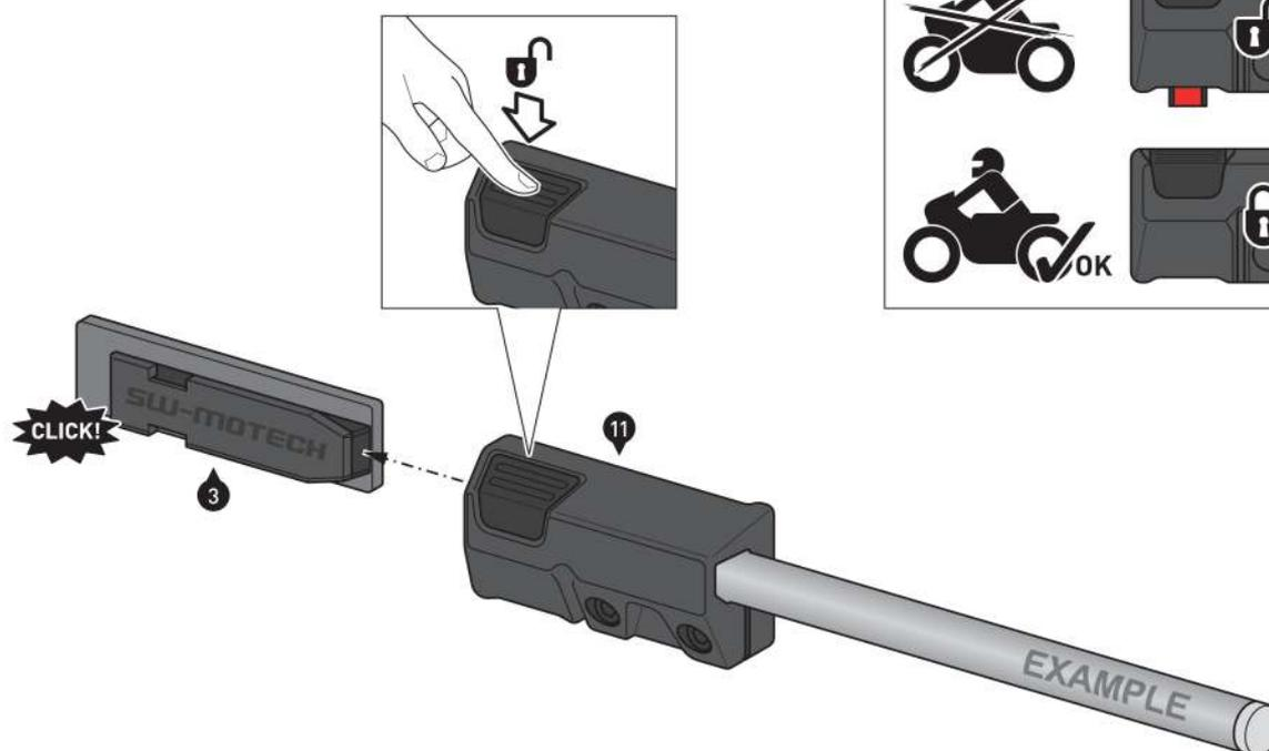
Deslice los conectores (11/12) a ambos lados por las guías de montaje (3/4).
