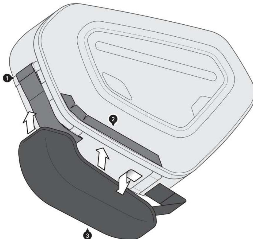
Enganche la correa de velcro del protector térmico (3) al bucle delantero de la parte inferior de la alforja BLAZE.
