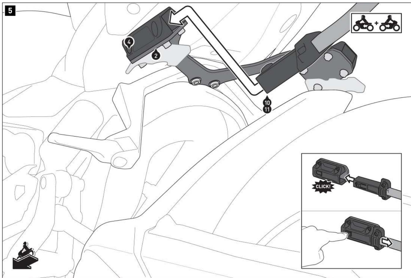
Inserte los conectores (10) / (11) en los soportes de los conectores (2) a ambos lados.
