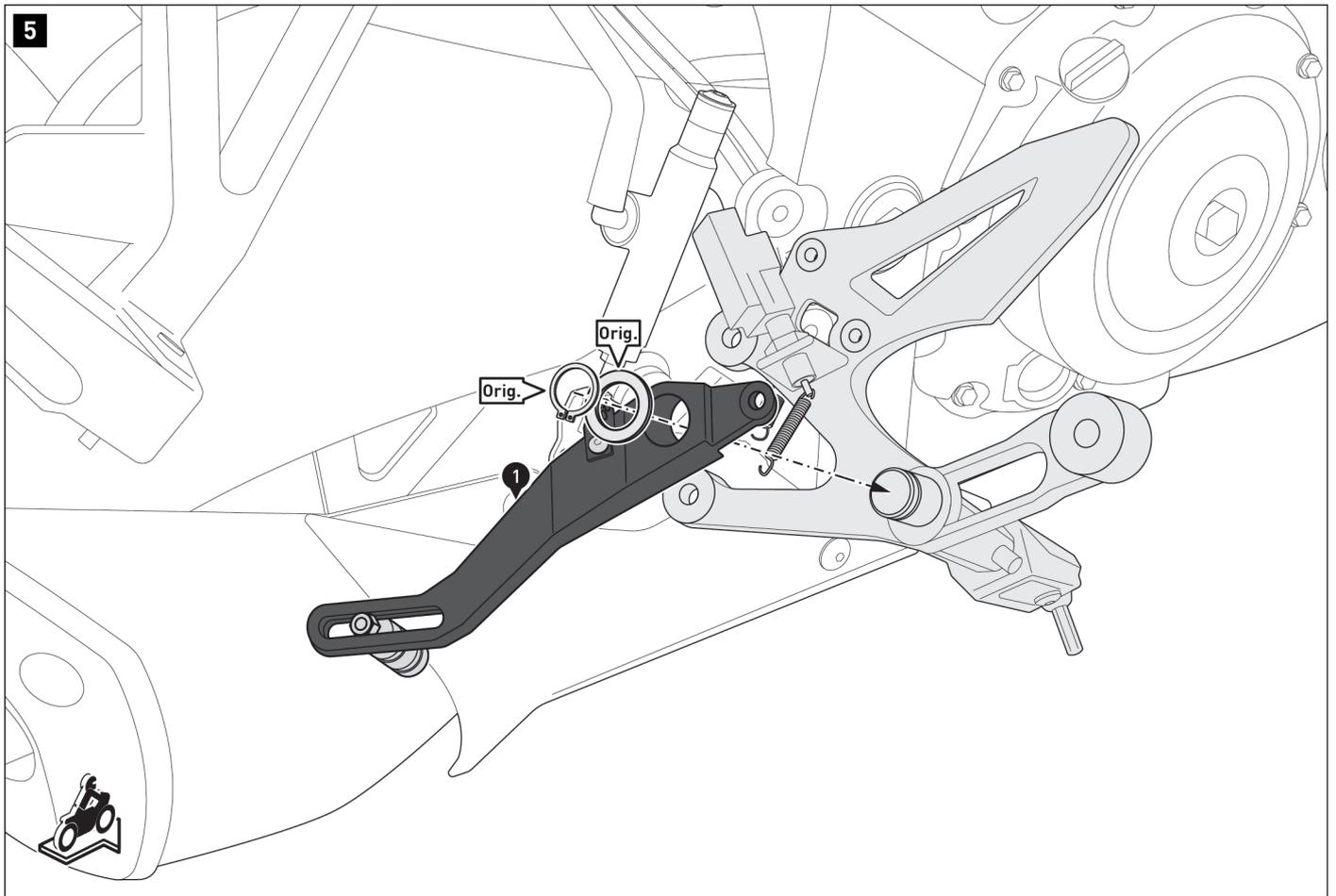
Instale el pedal de freno (1) en el soporte del reposapiés utilizando las piezas originales (Orig.).
