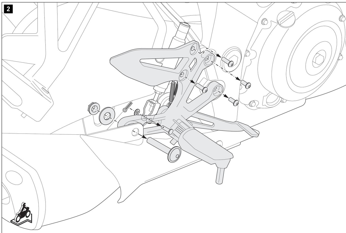
Afloje la chaveta de seguridad de la varilla de presión del cilindro maestro.
