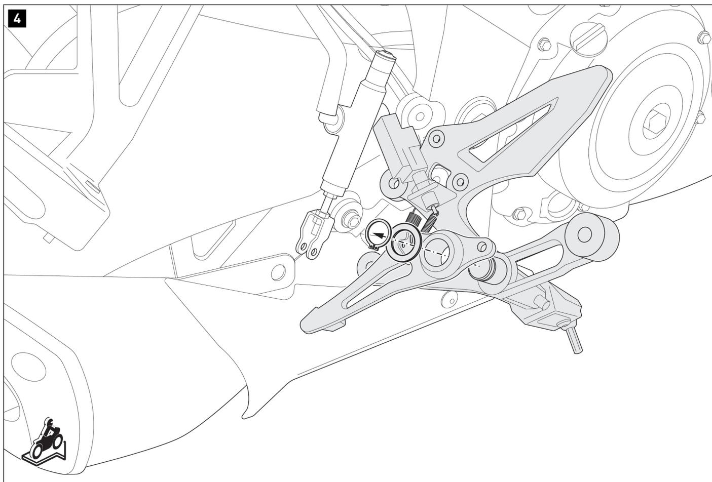
Retire el pedal de freno original del soporte para reposapiés.
