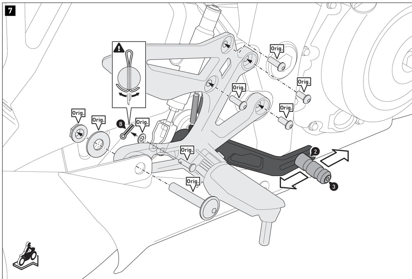
Instale la varilla de compresión con el pasador de seguridad (8).
