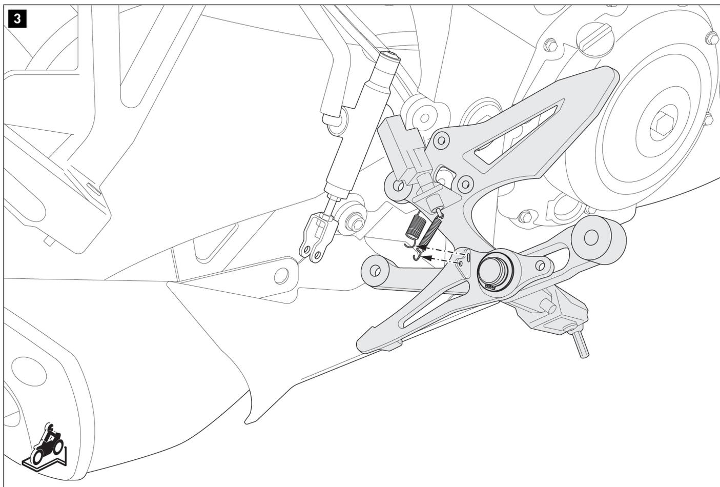
**⚠ NOTA:** Antes de desmontar el pedal de freno original, anote la posición de los resortes originales.
