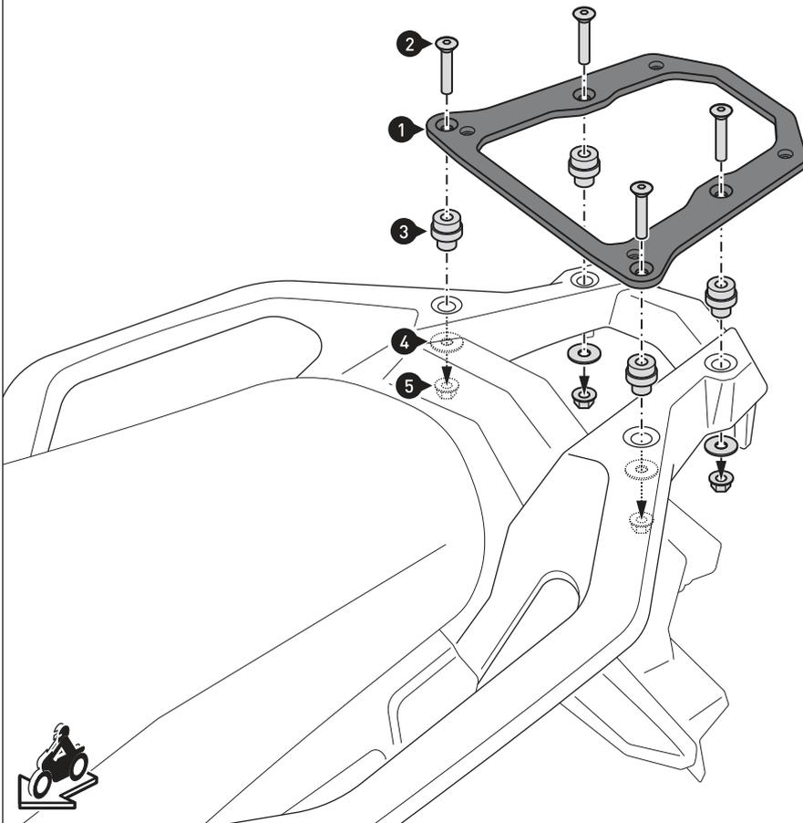
Verschrauben Sie das Anbaublech (1) am Fahrzeug. Ziehen Sie die Schrauben wie vorgegeben an.
