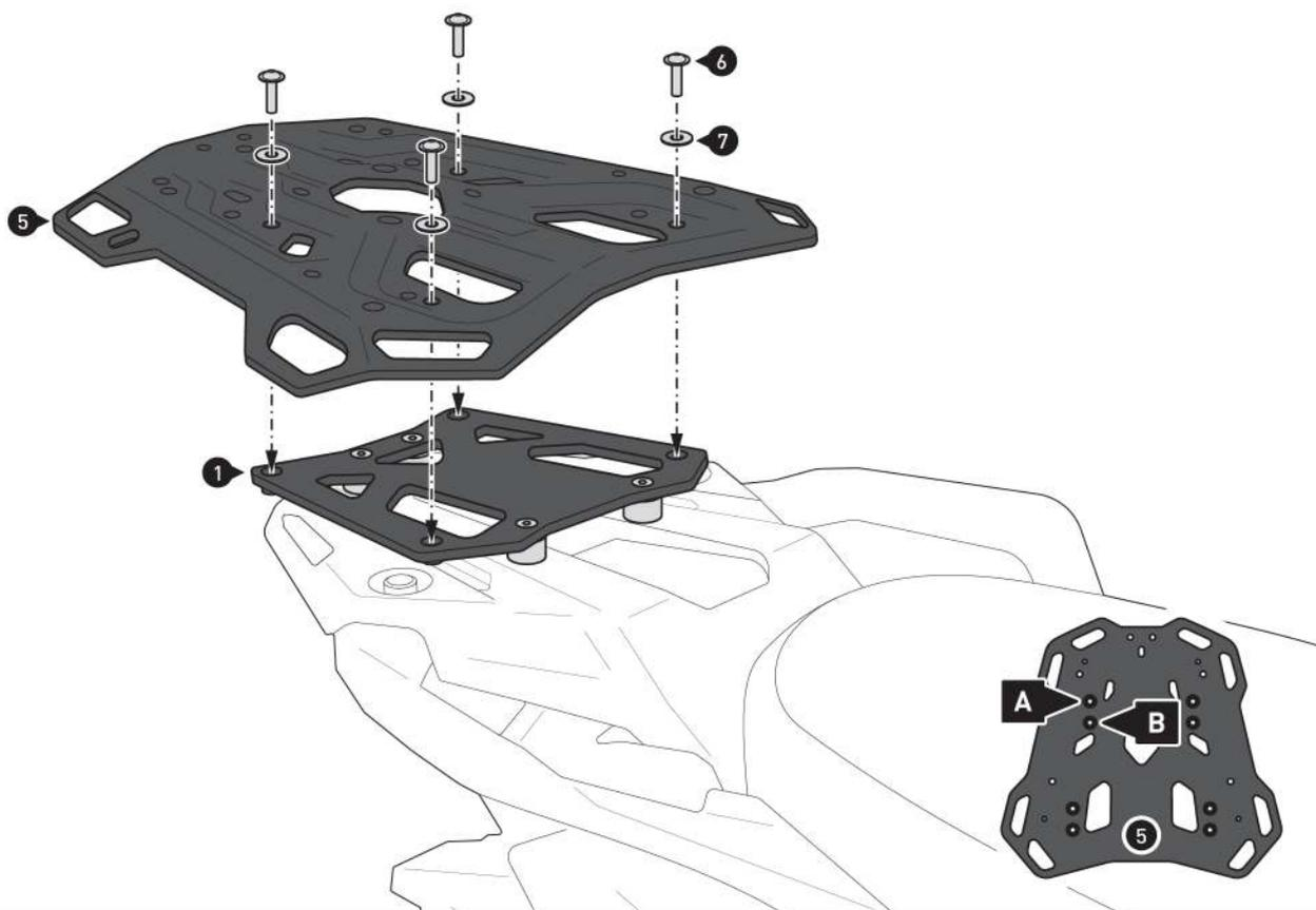
⚠ **NOTA:** Atornille el portaequipaje en la **posición de montaje marcada (A) o (B)**, según el espacio disponible, como se muestra en el dibujo de detalle.
