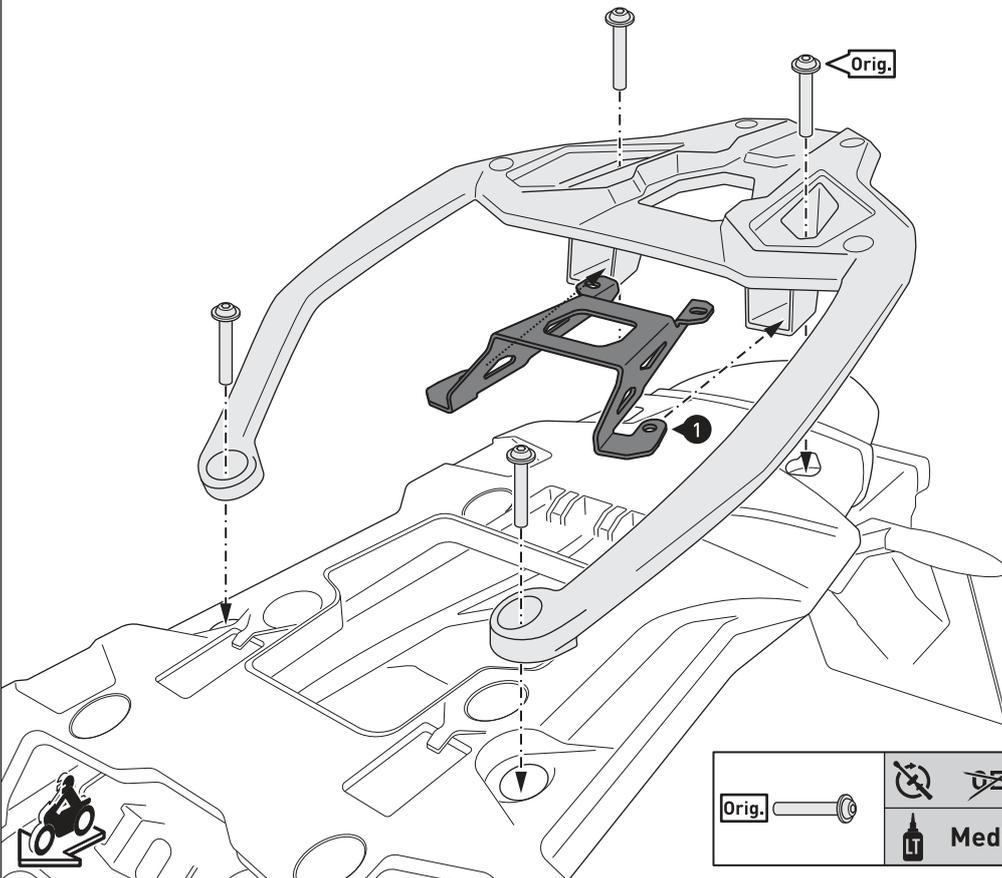
Verschrauben Sie das Anbaublech (1) mit dem Gepäckträger und den original Schrauben (Orig.) am Fahrzeug, wie in der Zeichnung gezeigt.
