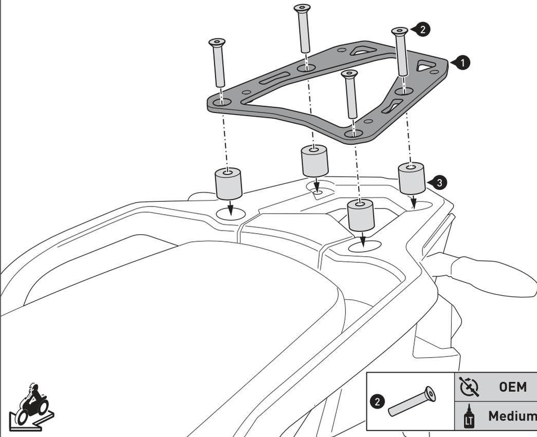
Montieren Sie das Anbaublech (1) am Fahrzeug.
