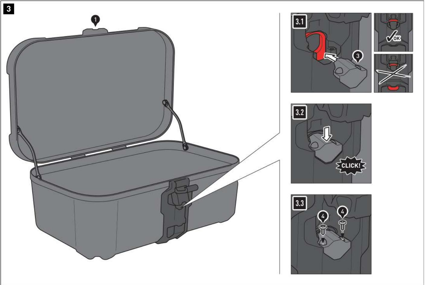
**Instalación del conector de cierre de la caja**
