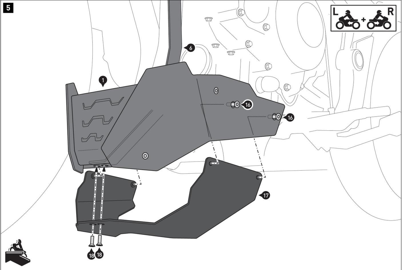
Atornille la placa de fijación (17) a la placa de fijación (6) y al protector de motor (1) por dentro.
