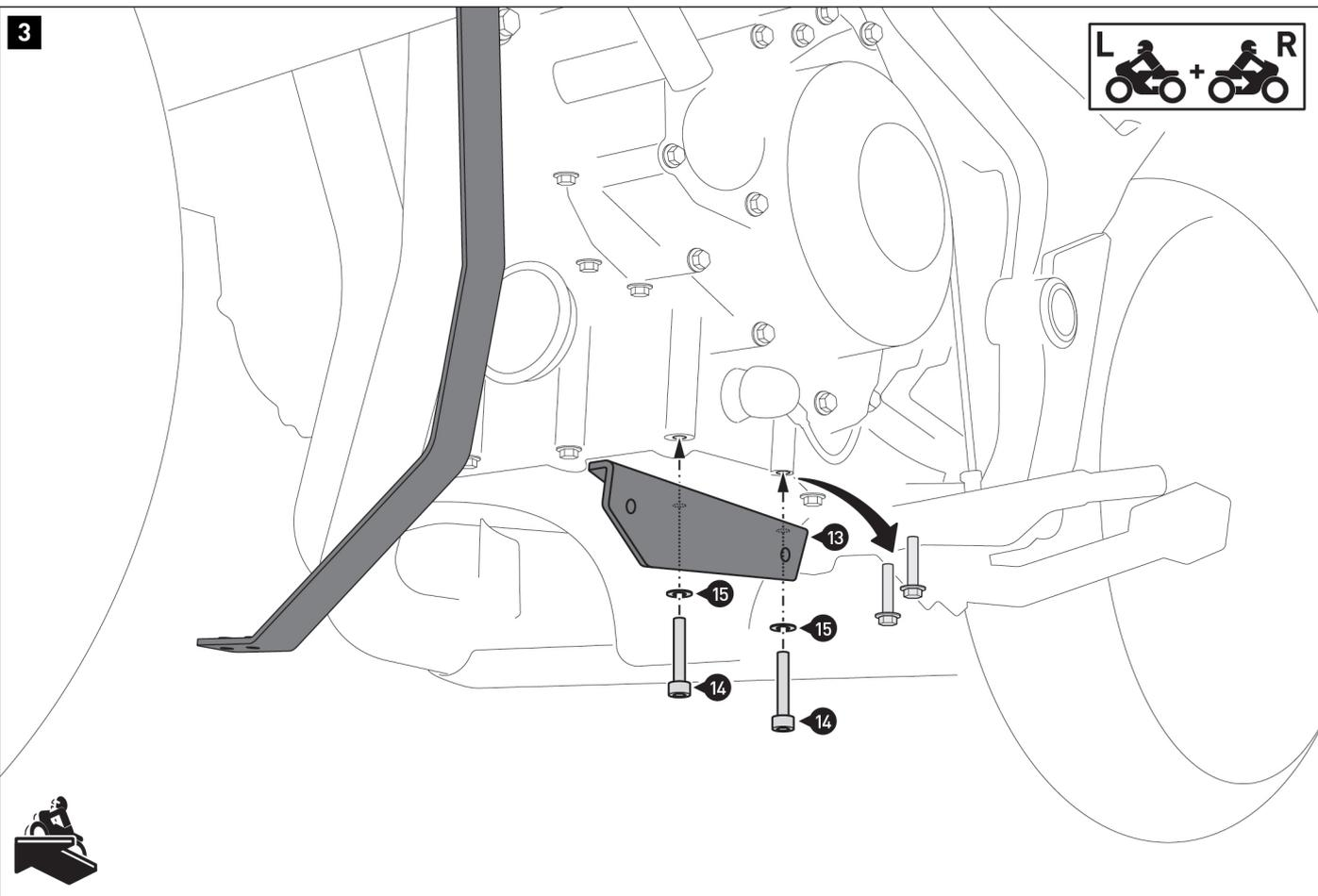
Retire los tornillos de los puntos de fijación indicados en ambos lados del vehículo.
