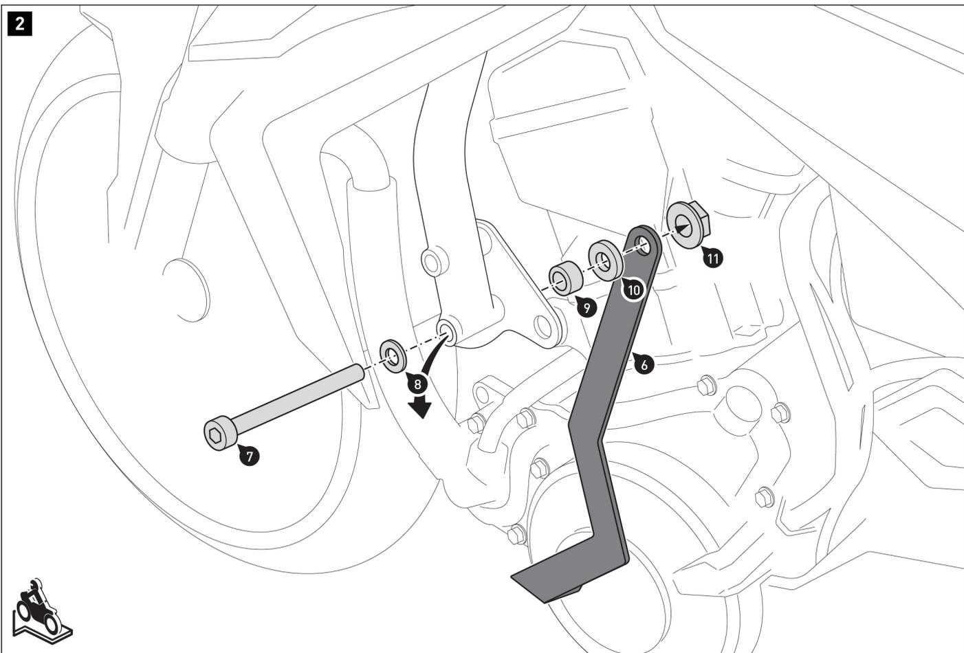
⚠ **NOTA:** Si se instala al mismo tiempo que la protección lateral de motor de SW-MOTECH, no es necesario el espaciador (10).
