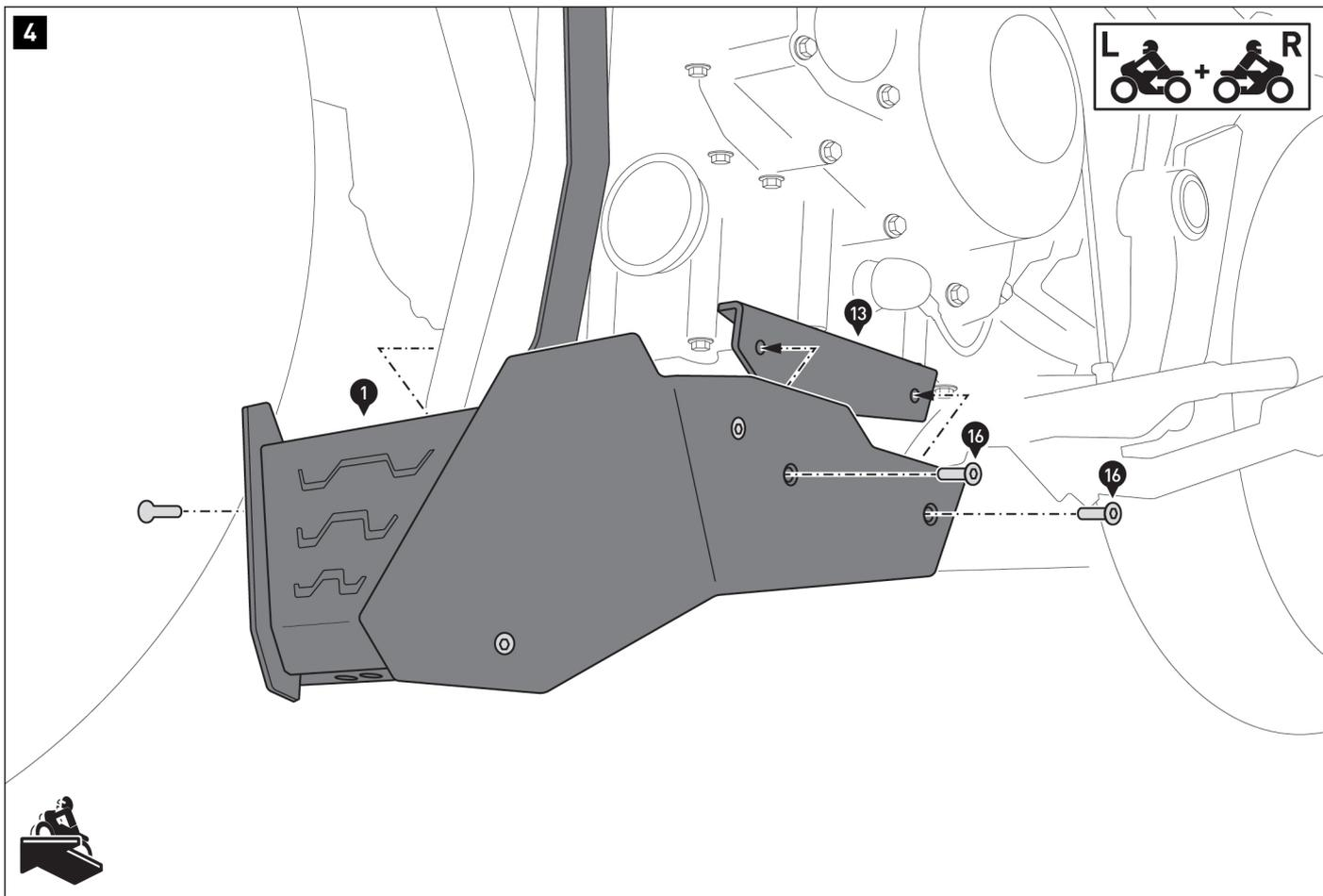
Utilice los tornillos [16] para fijar el protector de motor (1) a las placas de fijación (12) y (13) en ambos lados.
