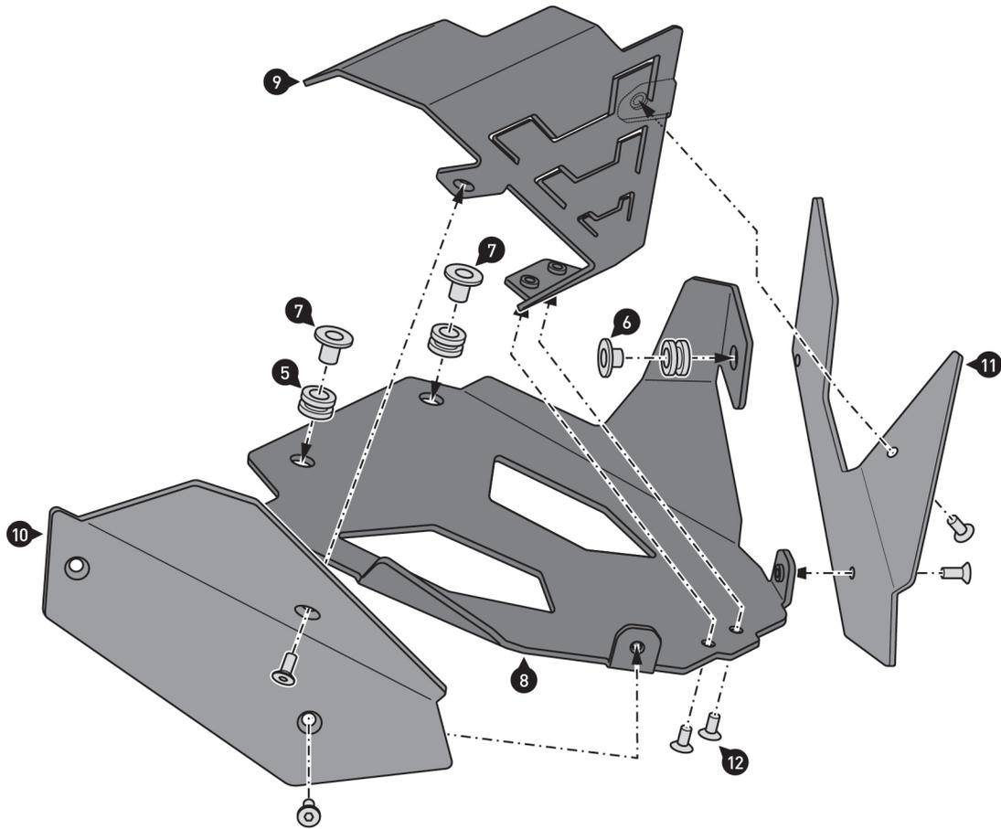
Inserte las arandelas de goma (5) en los orificios de la parte inferior del protector de motor (8). Luego presione los respectivos espaciadores (6) y (7) en la abertura de las arandelas de goma (5).
