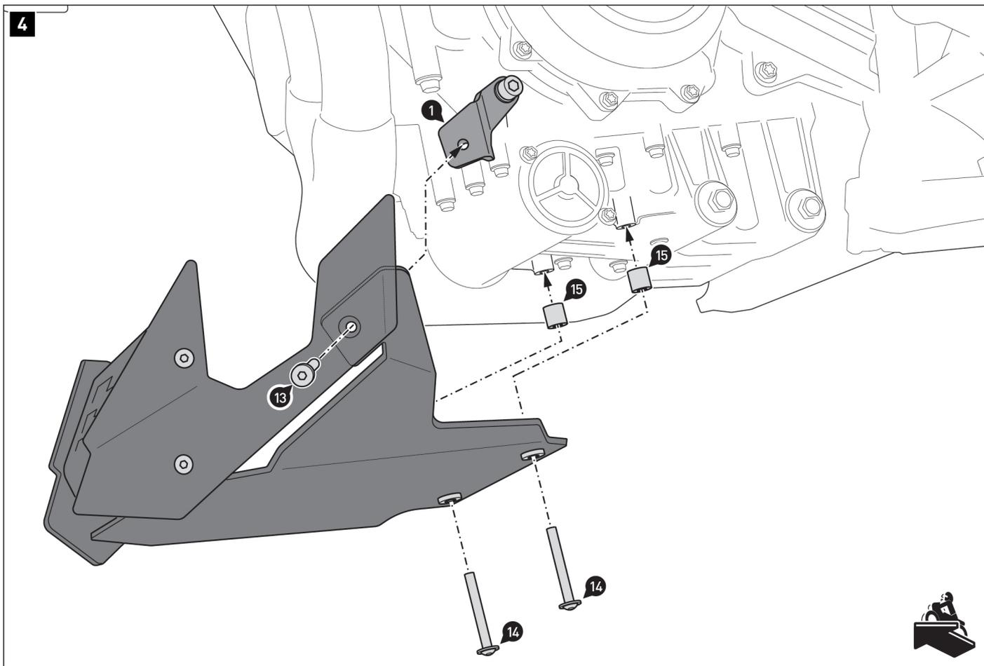
Atornille el protector de motor a la placa de fijación (1) y al vehículo.
