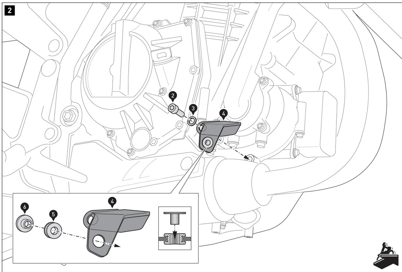
Inserte la arandela de goma (5) en el orificio que se muestra en la placa de fijación (4). Luego presione el espaciador (6) en la abertura de la arandela de goma (5), tal y como se muestra en la vista de detalle.
