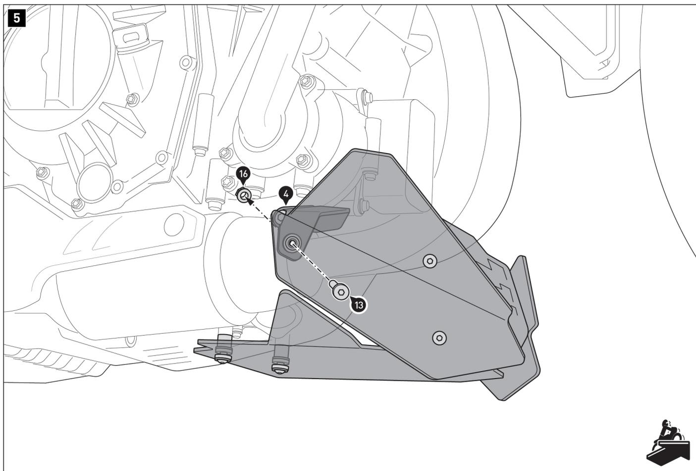
Atornille el protector de motor a la placa de fijación (4).
