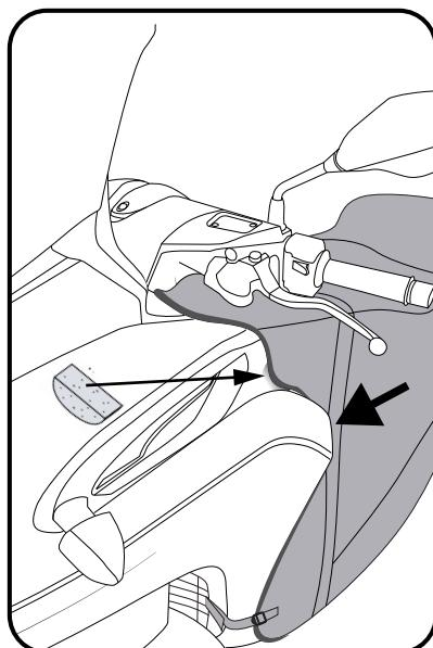
**I** Attenzione a far passare il Termoscud all'interno dello spigolo della carrozzeria.
