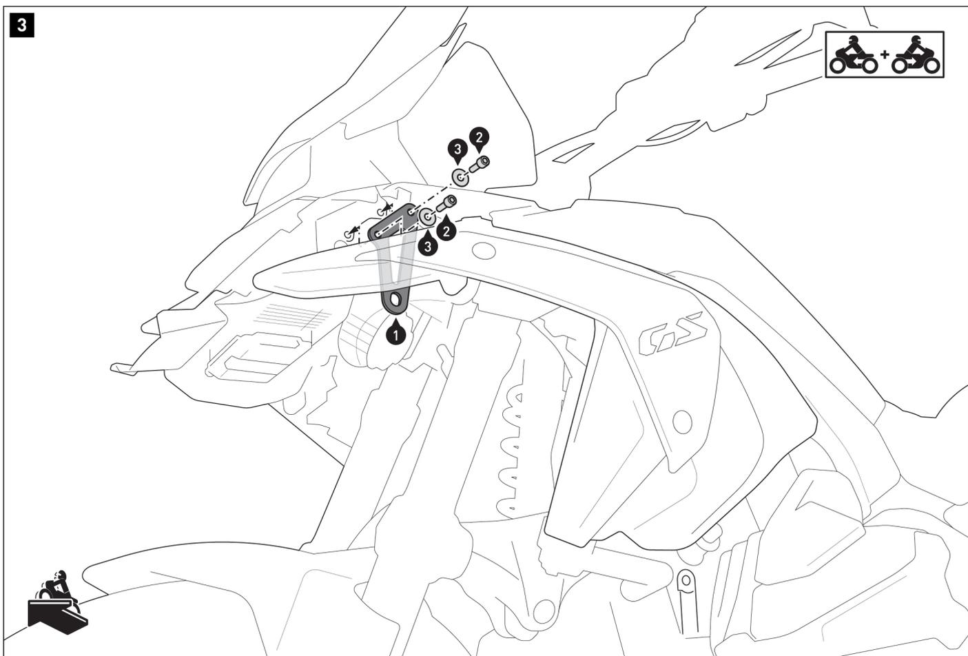
Atornille las placas de fijación (1) a ambos lados del vehículo. Asegúrese de que los cables situados en los puntos de fijación pasen por el interior de las placas de fijación.
