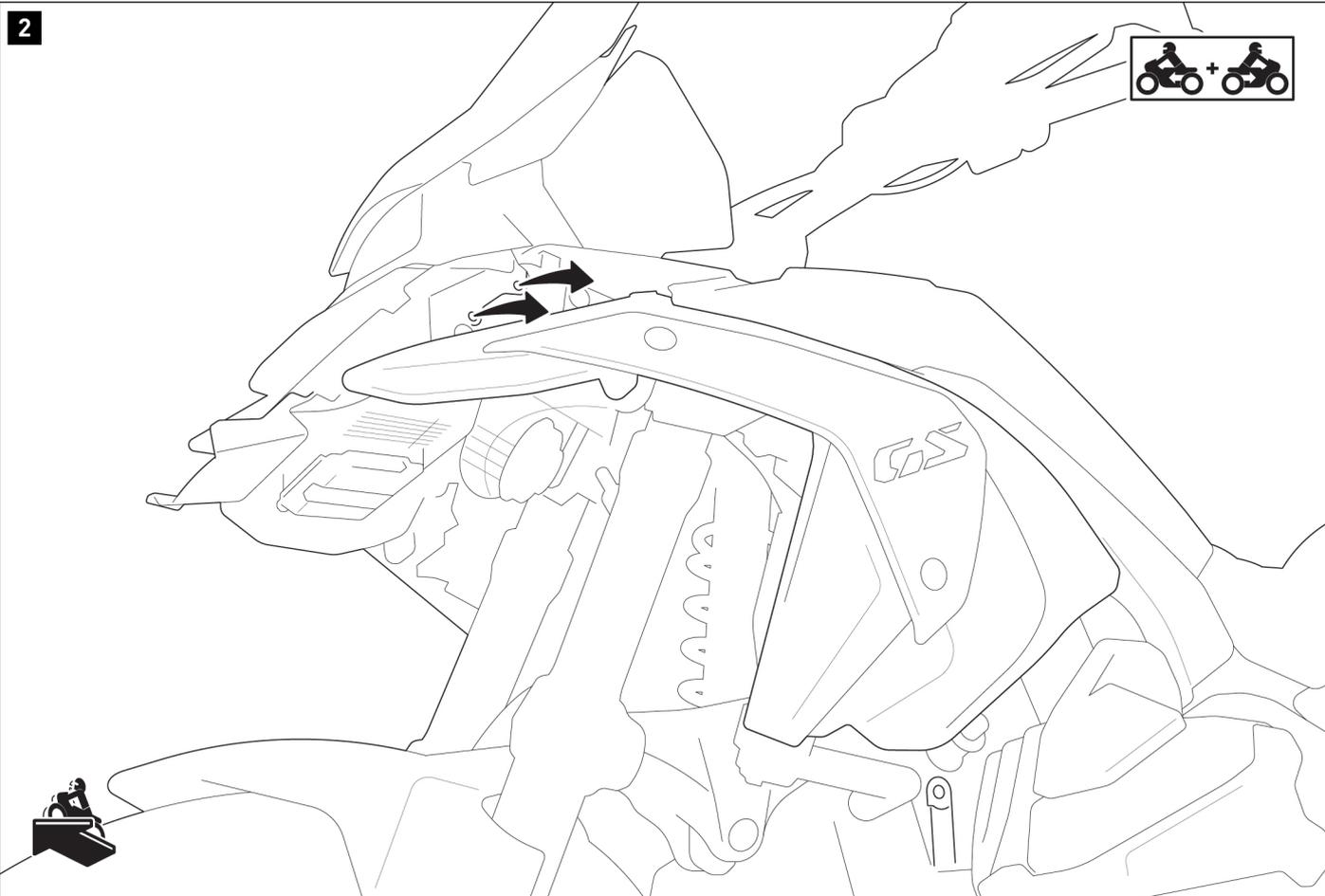
Retire del vehículo los tornillos indicados de ambos lados.
