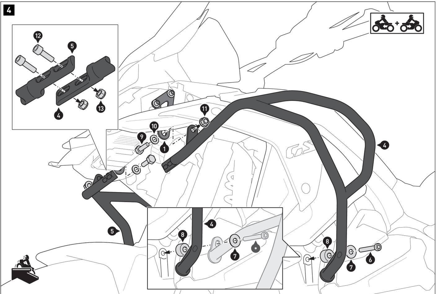
**⚠ NOTA:** Si este producto se va a instalar con la protección lateral de motor de SW-MOTECH, la instalación en el punto de fijación inferior varía (consulte el dibujo de detalle que figura a continuación). Utilice los tornillos (\*) que se incluyen con la protección lateral de motor.
