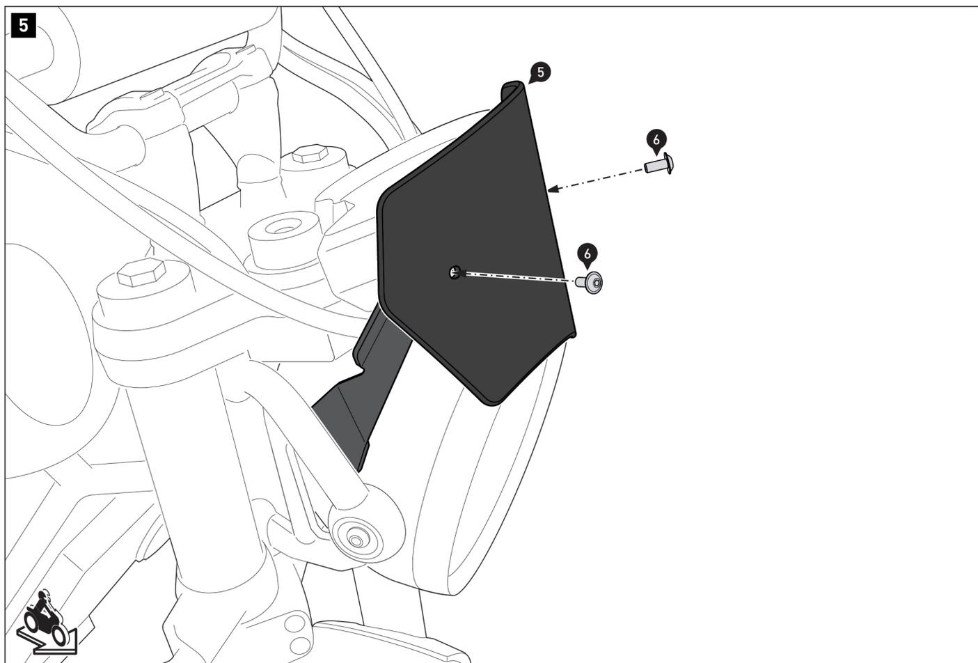
Atornille el parabrisas (5) a las placas de fijación (1) y (2).
